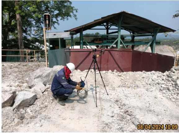
รูปที่ 4.3-4 แสดงการตรวจวัดค่าความทึบของฝุ่นละออง (Opacity) บริเวณบนปากไม่ วันที่ 8 เมษายน 2567
