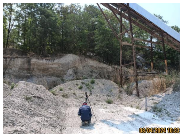
รูปที่ 4.3-8 แสดงการตรวจวัดค่าความทึบของฝุ่นละออง (Opacity) บริเวณจุดกองแร่ วันที่ 8 เมษายน 2567
