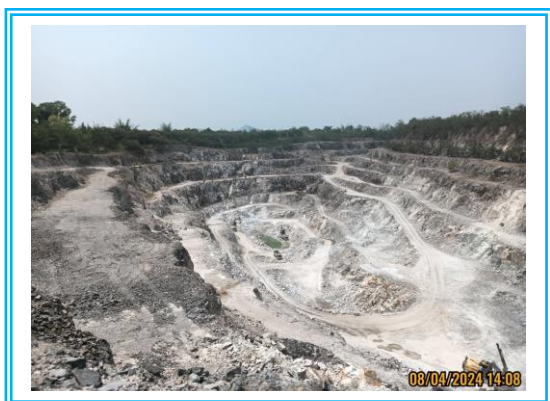
รูปที่ 2.3-1 หน้าเหมืองแบบขั้นบันได
