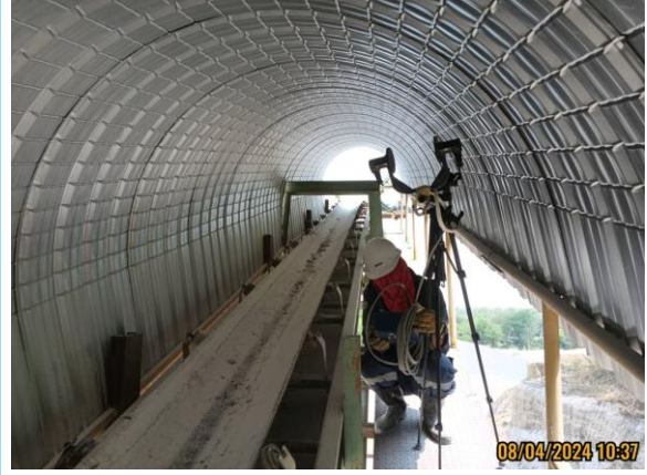
รูปที่ 4.3-5 แสดงการตรวจวัดค่าความทึบของฝุ่นละออง (Opacity) บริเวณบาร์แมค (เครื่องบดย่อย) วันที่ 8 เมษายน 2567
