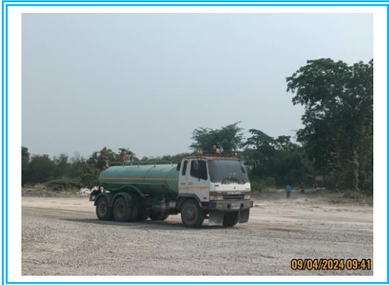
รูปที่ 2.3-5 รถฉีดพรมน้ำเพื่อลดการฟุ้งกระจายของฝุ่นละอองบริเวณโรงแต่งแร่ และเส้นทางขนส่งแร่
