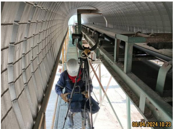
รูปที่ 4.3-6 แสดงการตรวจวัดค่าความทึบของฝุ่นละออง (Opacity) บริเวณจุดถ่ายโอนสายพานลำเลียง วันที่ 8 เมษายน 2567
