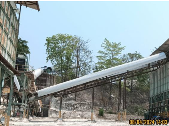
รูปที่ 3-9 อุปกรณ์ปิดคลุมสายพานลำเลียงแร่
