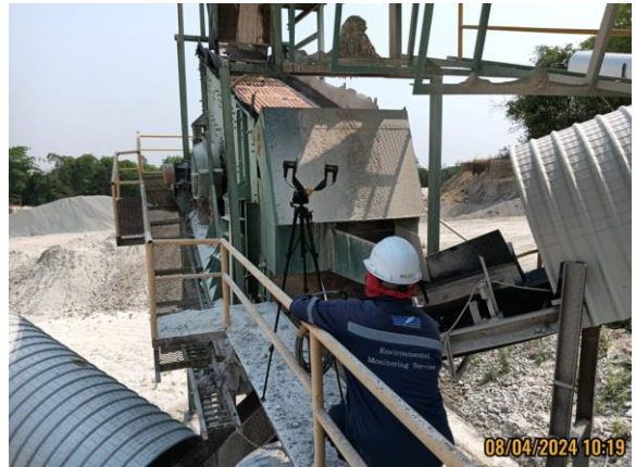
รูปที่ 4.3-7 แสดงการตรวจวัดค่าความทึบของฝุ่นละออง (Opacity) บริเวณตะแกรงคัดขนาด วันที่ 8 เมษายน 2567
